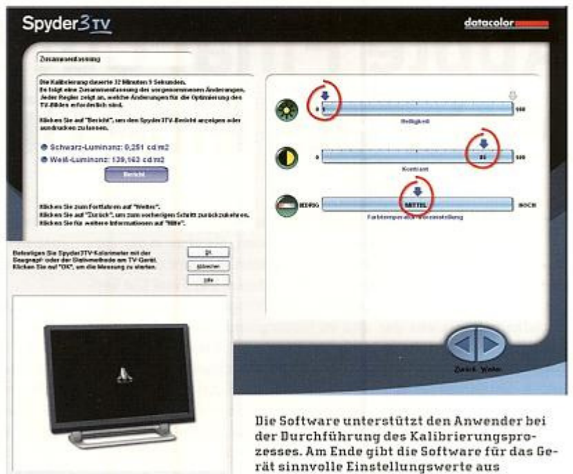
Im Zuge der Kalibrierung werden verschiedene Werte, hier für den Kontrast, getestet, bis die beste Einstellung gefunden ist
